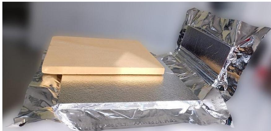
Cannon Afros LIFE VICORPAN Projekt soll das Potenzial zur Verbesserung der Energieeffizienz und Recyclbarkeit von vakuumoptimierten Isolierungen durch Kernformpaneele (**V**acuum improved **I**nsulation by **C**ORE shaped **P**ANels) aufzeigen. Foto: Cannon Gruppe
